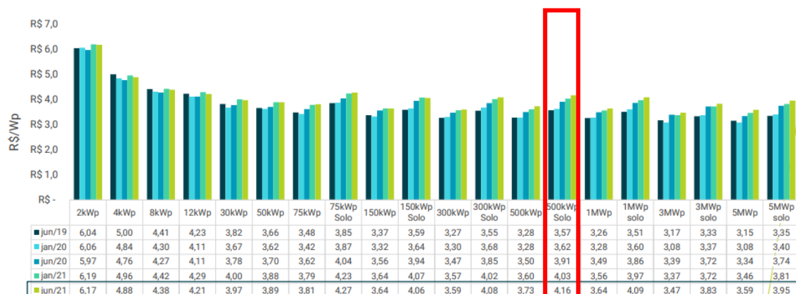
Figura 31 - demonstrativo dos custos médios por Wp de sistema fotovoltaico por faixa de potência e tipologia da instalação
