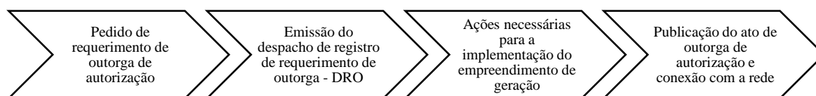
Figura 22 - Fluxograma do processo de requerimento de outorga para centrais geradoras acima de 5 MW
