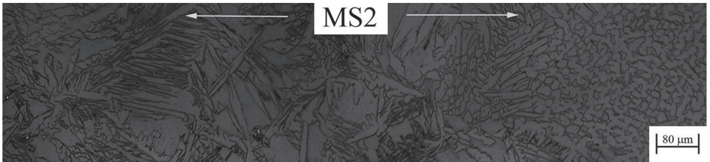
Figura 16. Metal de solda (MS2) da JPF5. Perfil ao longo do cordão solda (MS2). Variação de morfologia e da proporção de fases ao longo de um pequeno comprimento da junta.
