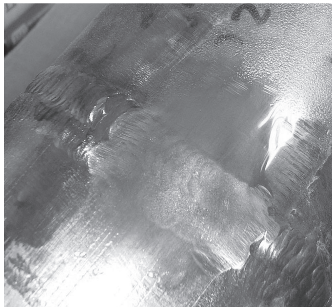
Figura 2. Superfície da junta soldada JPF3 após aplicação do reagente Beraha.
