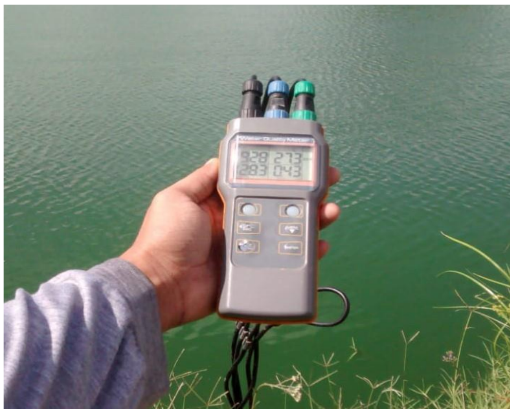
Figura 12 - Sonda multiparâmetro AKSO AK88 utilizada na aferição de oxigênio, salinidade, pH e temperatura.
