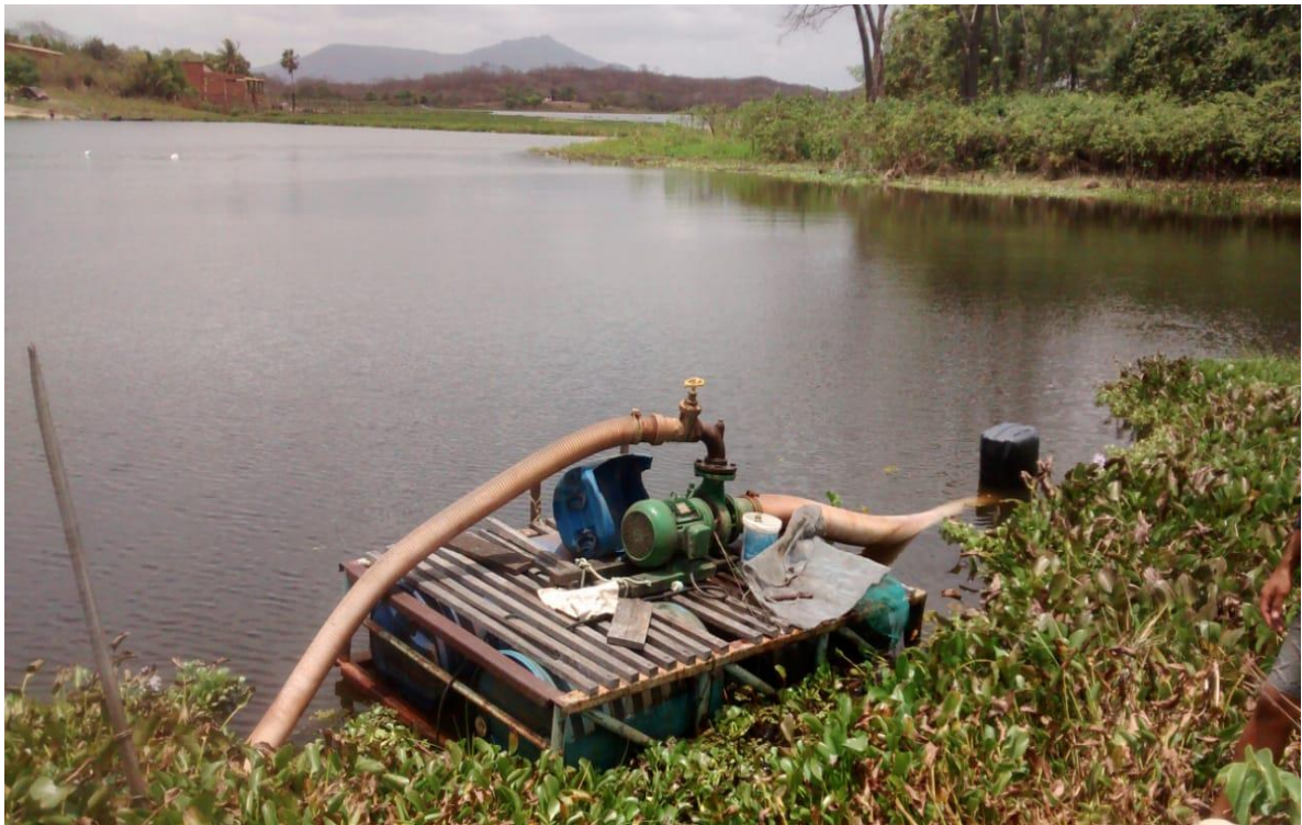
Figura 2 - Bomba com vazão de 10.000 L/h utilizada no abastecimento dos viveiros.
