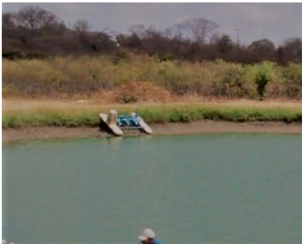
Figura 13 - Aerador de pá utilizado na incorporação de oxigênio na água.
