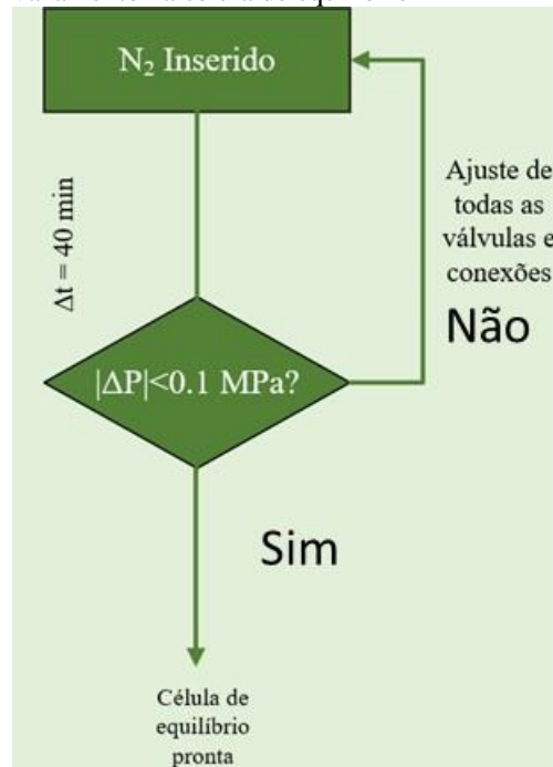
Figura 8 - Procedimento para checagem de vazamento na célula de equilíbrio
