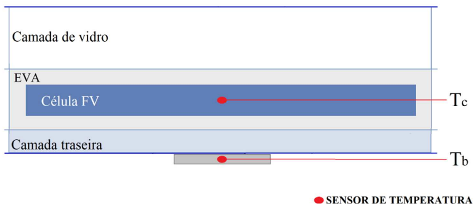
Figura 8: Posição de medição de T_c em relação à célula FV
