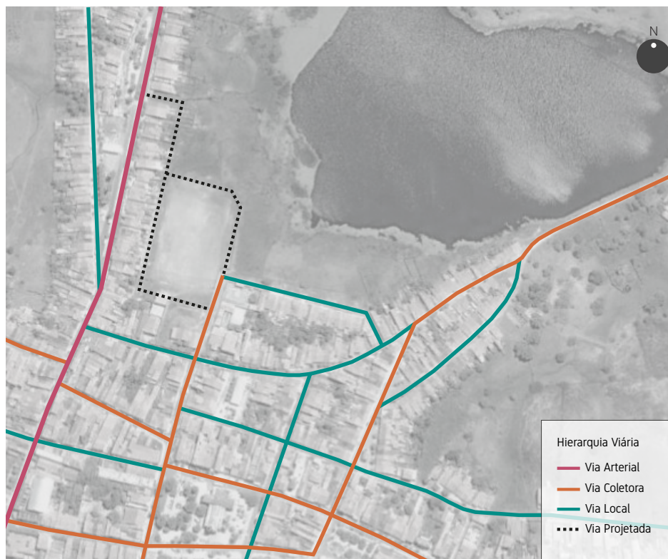
FIGURA 37 Mapa com a hierarquia viária no entorno do terreno de implantação da Clínica de Saúde Integrada. Fonte: desenvolvido pela autora, com base do Google Earth.
