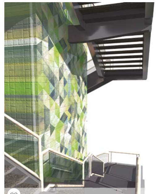
Fig 91 e 92 – A estrutura da escada em lance U se apoia nas vigas centrais do edifício e numa mísula que surge da coluna dos elevadores. O painel utilizado na escada é uma adaptação da autora de uma arte gráfica feita pelo designer e ilustrador americano Andy Gilmore. (Disponível em: http://crowquills.com/ )
