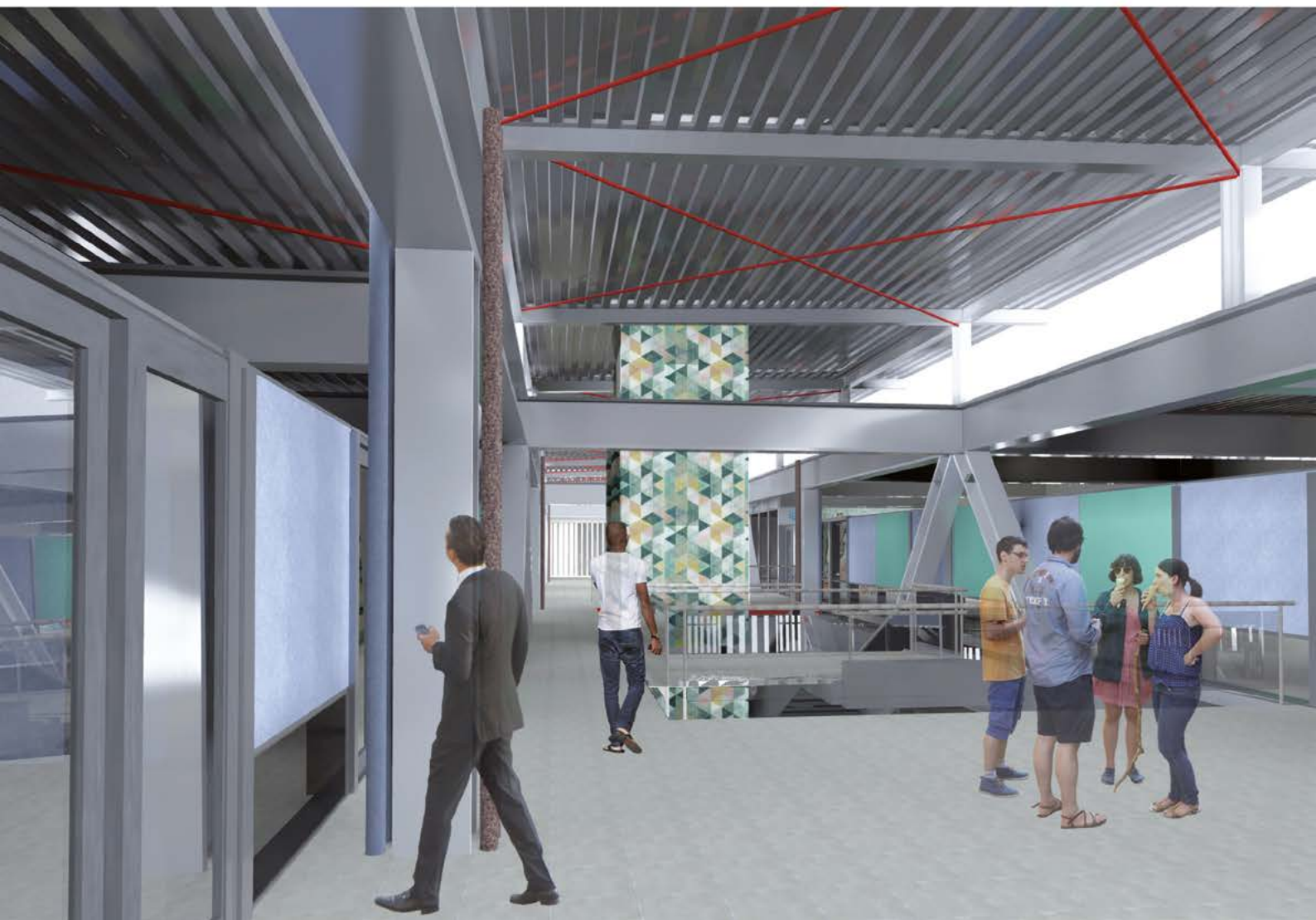
IMAGENS 12 e 13 - Vistas interna e externa dos ateliês e oficinas com vedações à meia altura (2,30m) favorecendo a ventilação cruzada e servindo como didática às instalações e estrutura aparentes.
