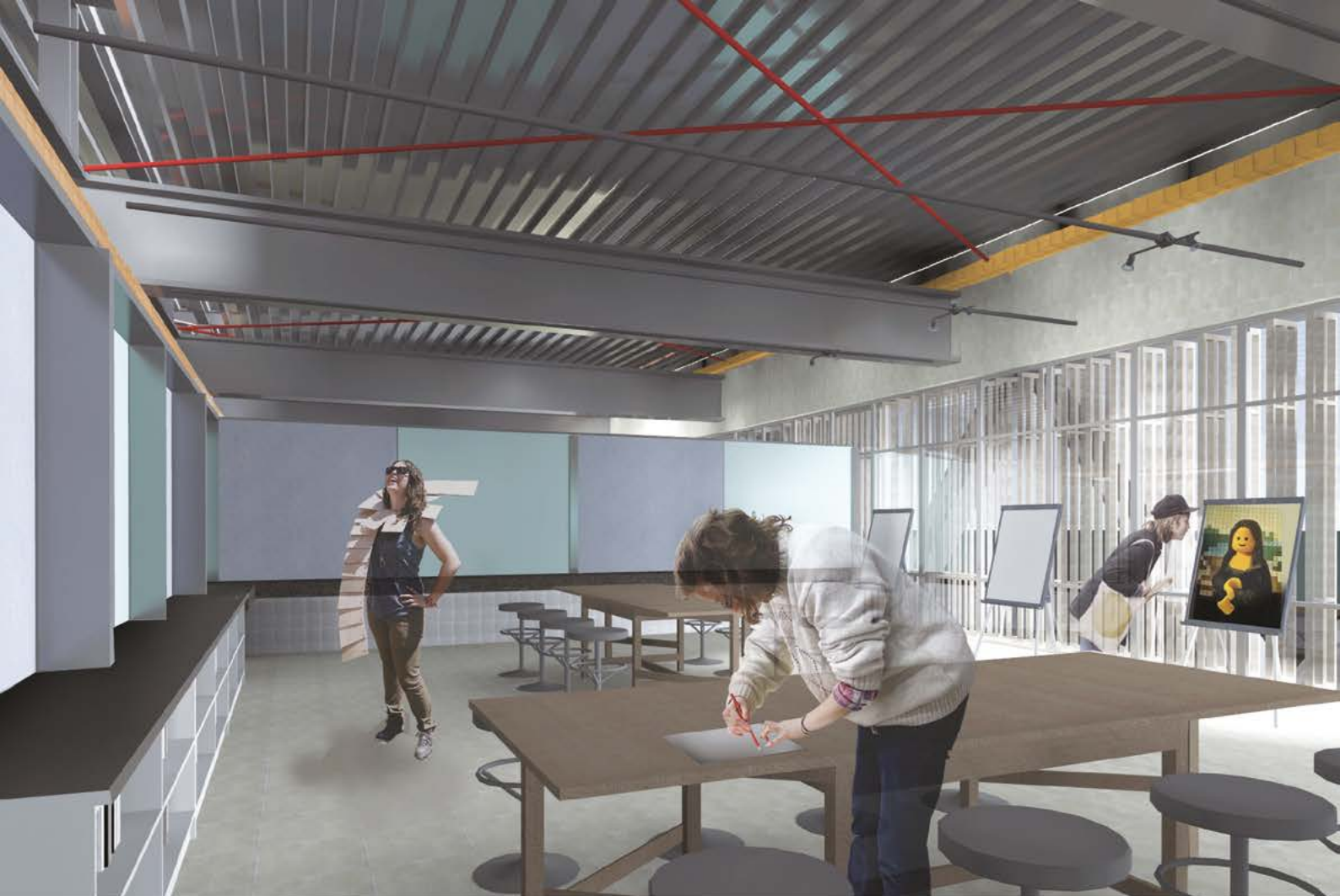
IMAGENS 12 e 13 - Vistas interna e externa dos ateliês e oficinas com vedações à meia altura (2,30m) favorecendo a ventilação cruzada e servindo como didática às instalações e estrutura aparentes.
