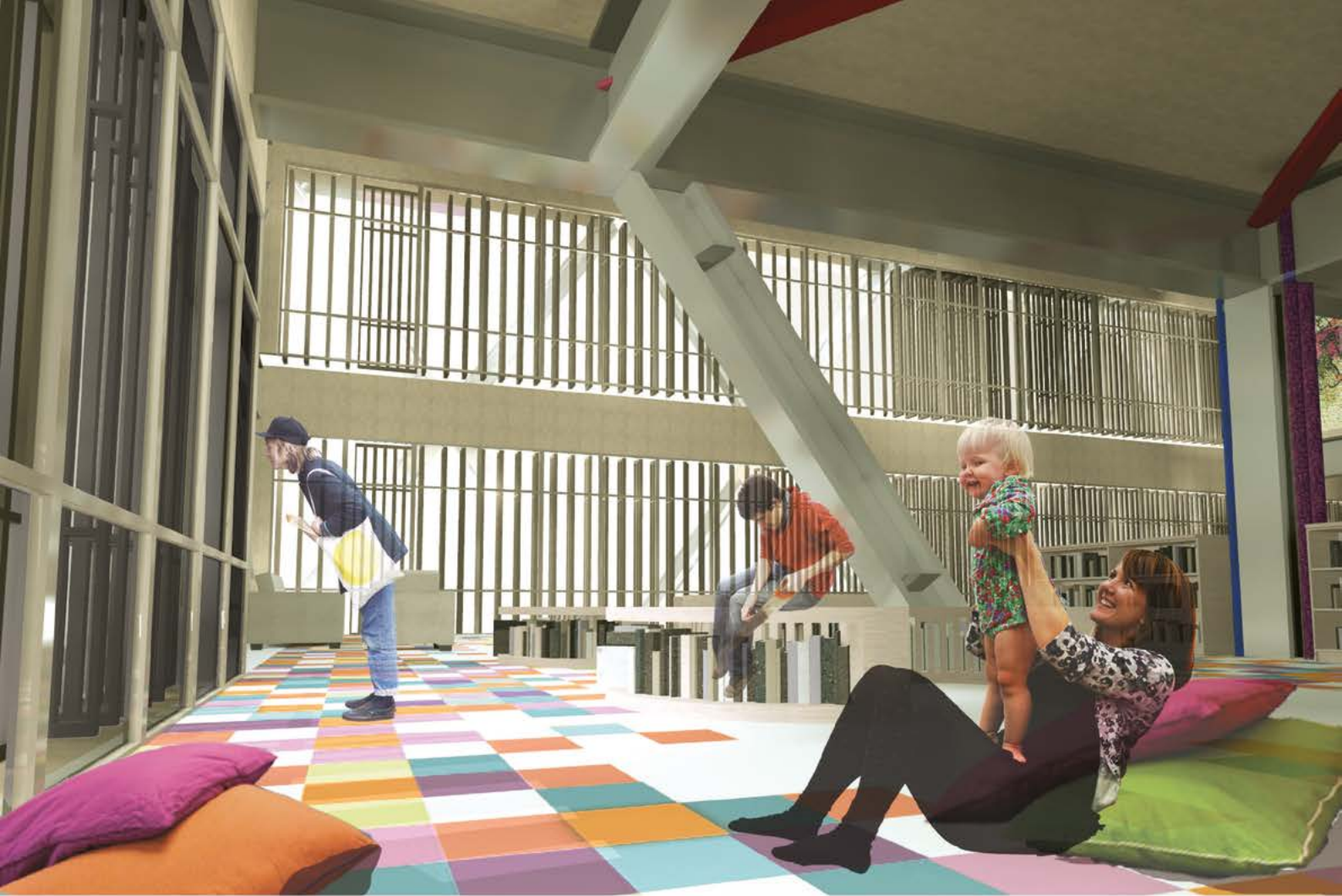
IMAGEM 7 - Abertura lateral com vidro detrás dos brises devido ao ambiente ar-condicionado da biblioteca.
