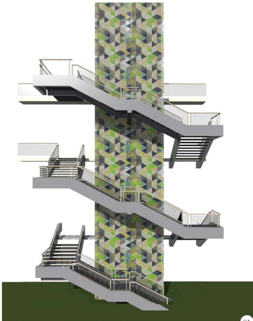
Fig 91 e 92 – A estrutura da escada em lance U se apoia nas vigas centrais do edifício e numa mísula que surge da coluna dos elevadores. O painel utilizado na escada é uma adaptação da autora de uma arte gráfica feita pelo designer e ilustrador americano Andy Gilmore. (Disponível em: http://crowquills.com/ )
