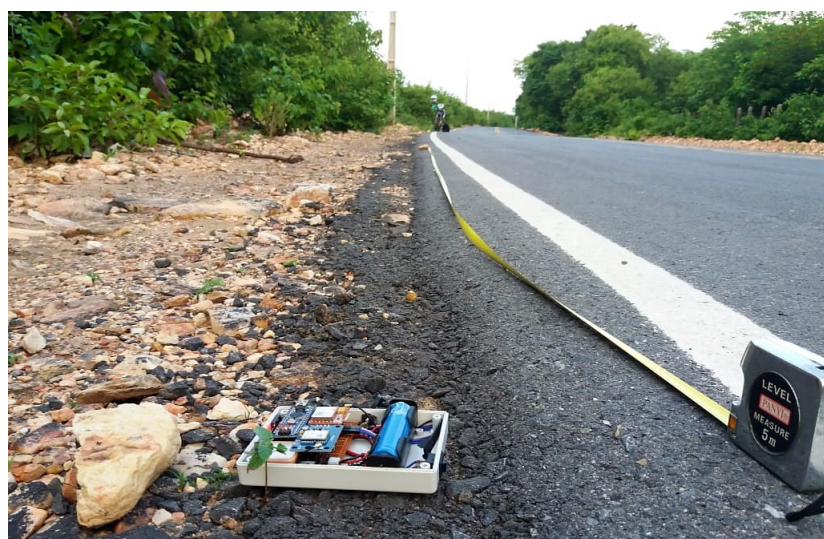
Figura 45 – Experimento com o GPS do dispositivo em zona rural.
