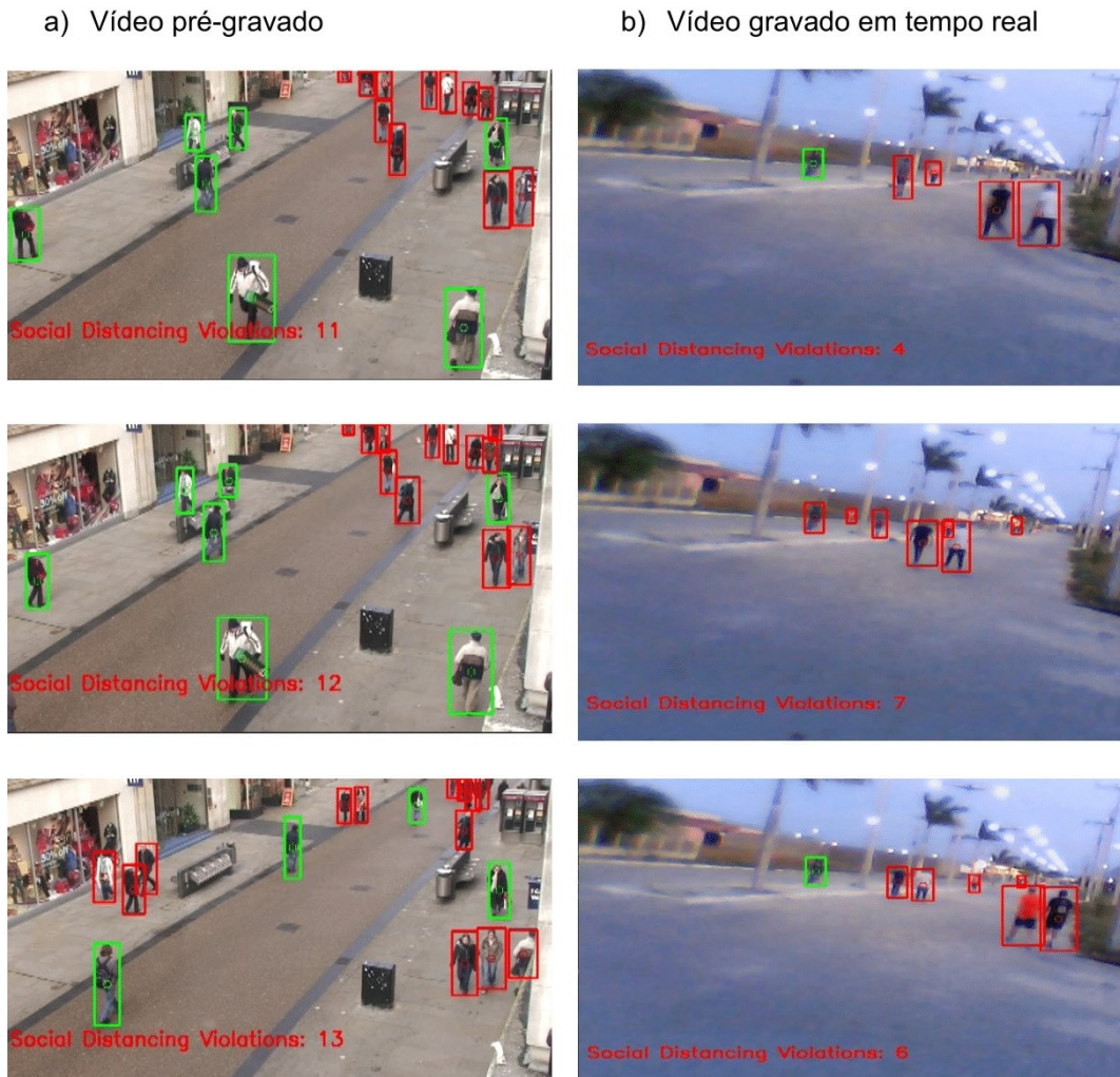
Figura 11 – Detecção de pessoas pela ferramenta desenvolvida
