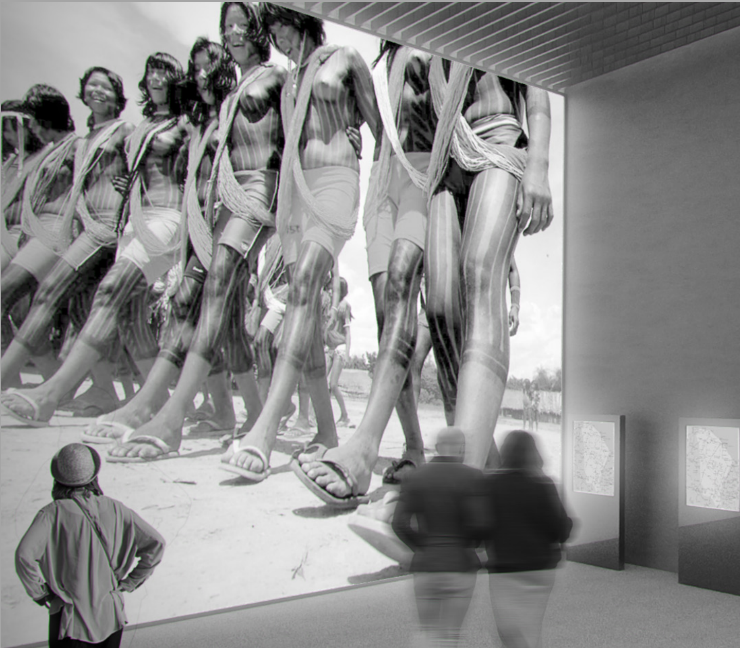
Fig. 50 - Setor de exposição de uma macrorregião do estado do Ceará. O forro obrigatoriamente utilizado para isolar a acústica de cada setor é composto por ripas de madeira espaçadas a 0,10m e um isolante de lã de rocha fixado acima desta estrutura. Como uma premissa do edifício, o ambiente é independente estruturalmente. Assim, o acréscimo eventual de macrorregiões ou a possível mudança de uso do edifício são permitidos.
