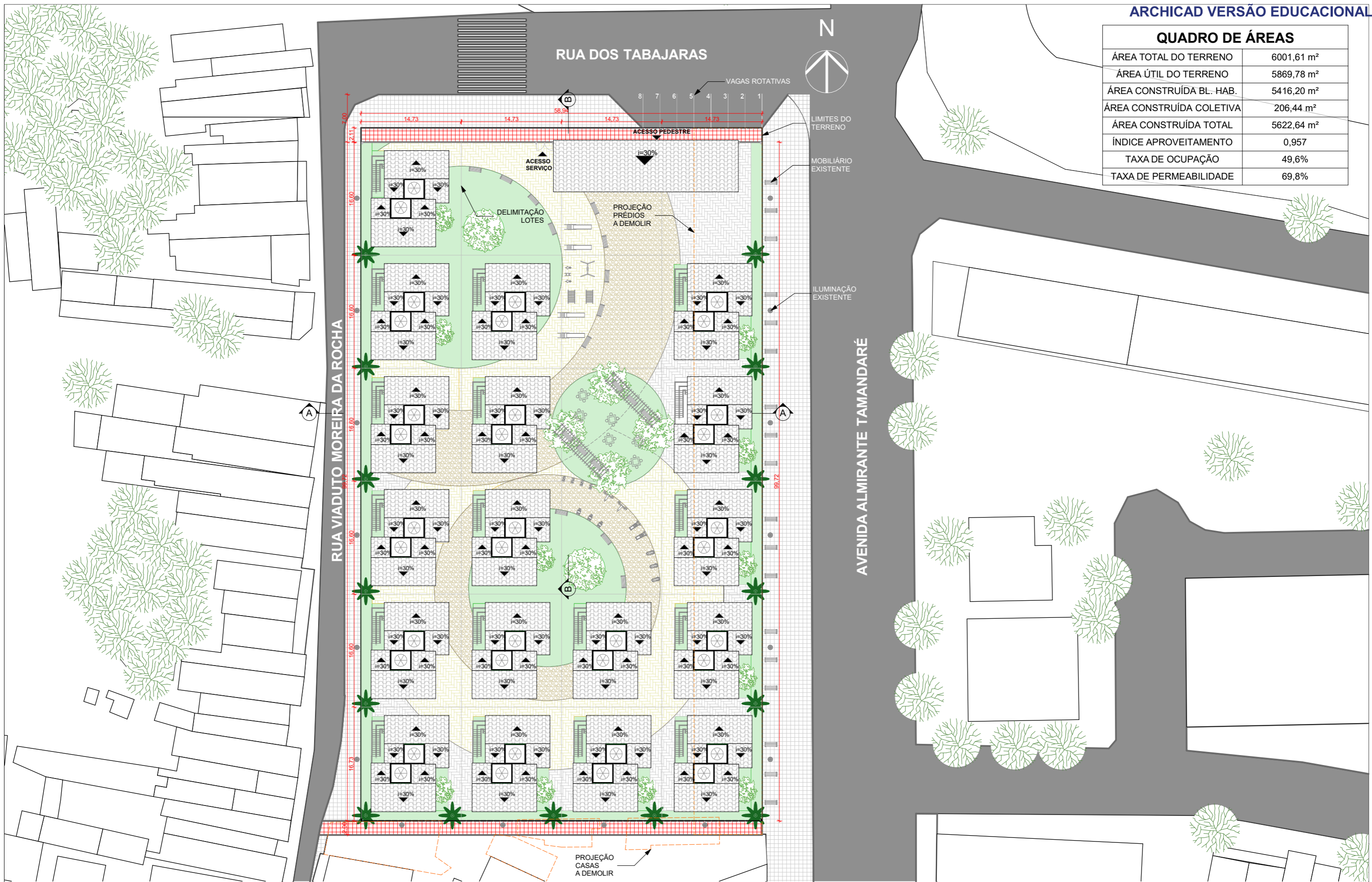
1 PLANTA DE SITUAÇÃO ESCALA 1:500
