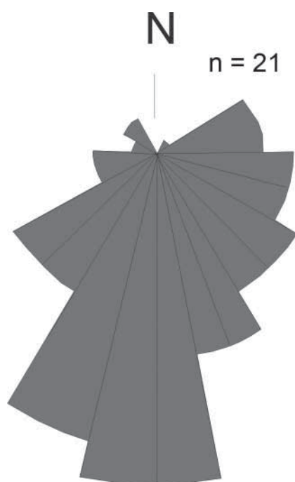
Figura 13. Diagrama em roseta que exibe padrão de dispersão de paleocorrentes medidas em estratificações cruzadas acanaladas e tabulares nas exposições estudadas da Formação Missão Velha. Legenda: n = número de medidas; N = indicação do norte.
