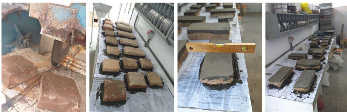
O rompimento dos tijolos foi feito em uma máquina de ensaios universal da marca EMIC, aplicando-se um carregamento de 500 N/s para o método da NBR 8492 (ABNT, 2012) e 0,05 MPa/s para o método da NBR 15270-2 (ABNT, 2017a). Em ambos os casos, o carregamento foi realizado em uma área de 100 x 100 mm dos tijolos, que estavam no estado saturado Figura 24.
