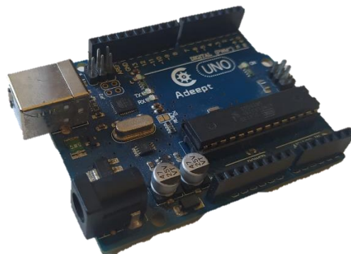
Figura 6 – Plataforma Arduíno Uno R3
