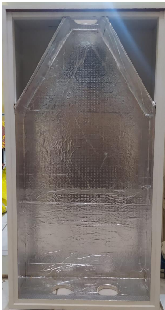
Figura 8 - Coletor solar com as hastes e o isolante térmico
