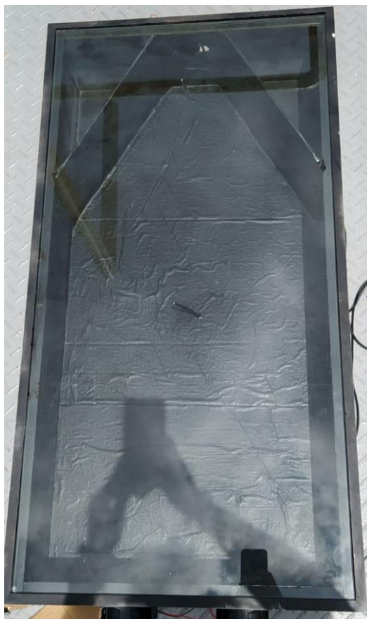
Figura 9 – Coletor solar térmico com revestimento escuro e com Placa de vidro
