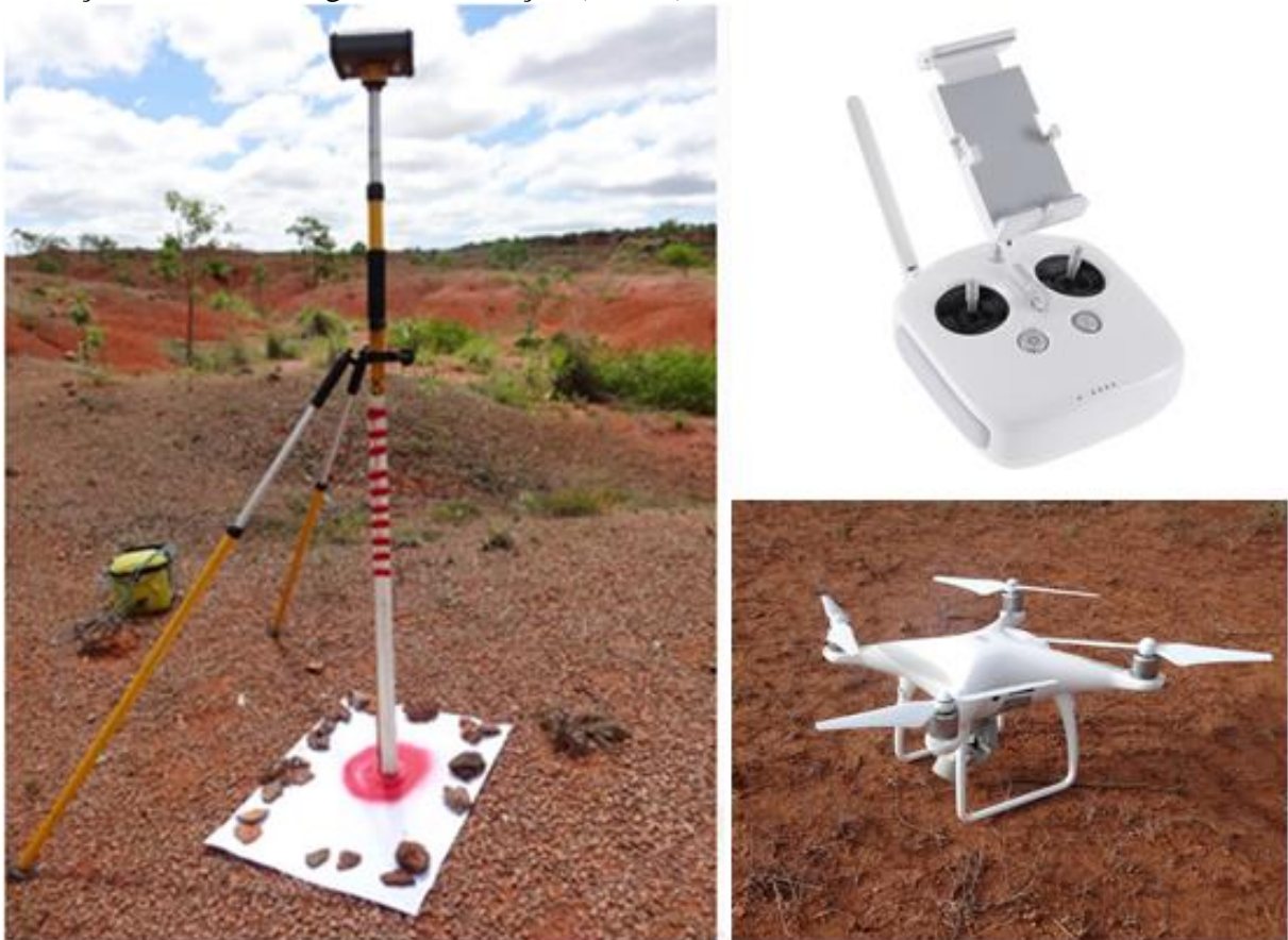
Figura 9 – Equipamento utilizado para caracterização topográfica da área de estudo e obtenção de modelos digitais de elevação (MDEs)
