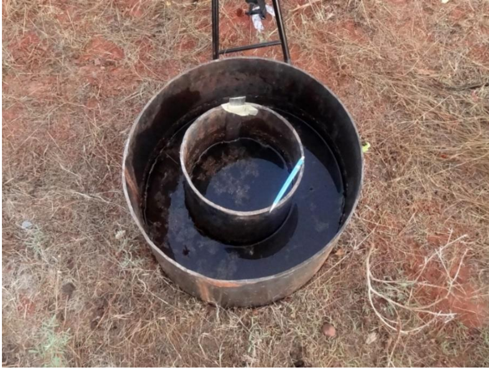
Figura 25 – Medição da taxa de infiltração da água no solo pelo método dos cilindros concêntricos em Gilbués-PI (2019)
