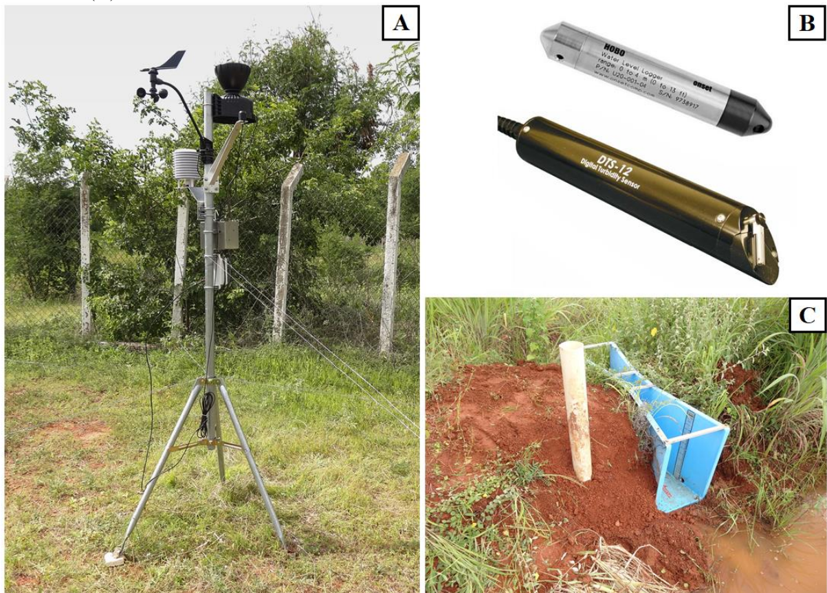
Figura 8 – Estação meteorológica (A); sensores de turbidez e pressão (B); medidor de vazão Parshall (C)
