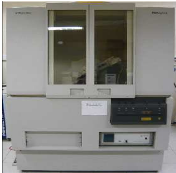
Figura 3.6 – Difratorômetro de Raios-X
