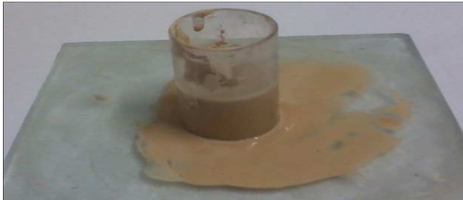
Figura 4.12 – Mistura da amostra com água para obter a pasta de consistência normal.
