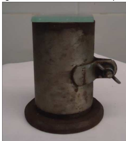
Figura 3.10 – Molde do corpo de prova
