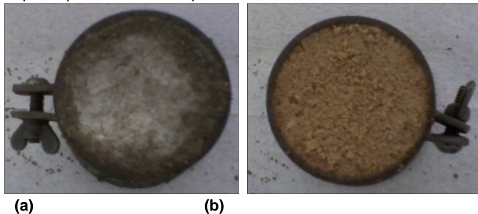
Figura 4.13 – (a) Corpo de prova do cimento de referência moldado e (b) corpo de prova do material produzido moldado.
