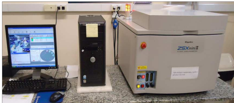
Figura 3.5 – Equipamento utilizado para análise química de fluorescência de raios-X
