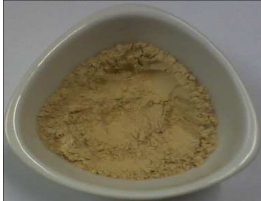
Figura 3.8 – Recipiente de porcelana, utilizado para mistura do material com água destilada.
