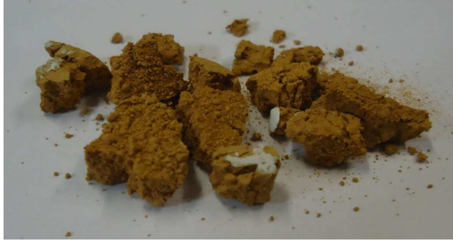
Figura 4.10 – Mistura de borra de alumínio, PCCs e 5% de carbonato de cálcio e magnésio \text{CaMg}(\text{CO}_3)_2 , após a sinterização de 1200^\circ\text{C} .
