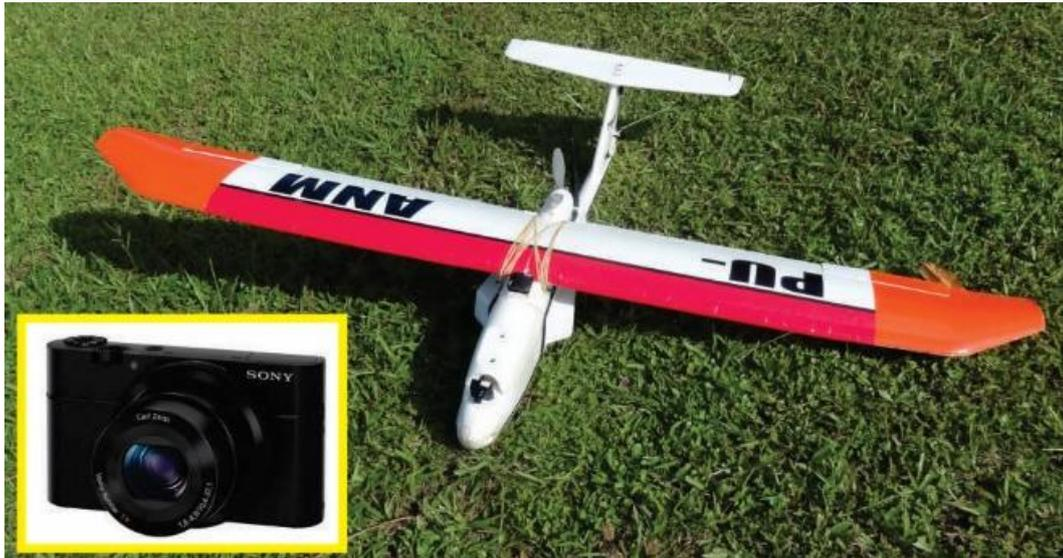
**Figura 4:** VANT desenvolvido pela UnB em parceria com o DNPM. No detalhe, a câmara não métrica, modelo DSC-RX100, empregada na obtenção das aerofotos.
