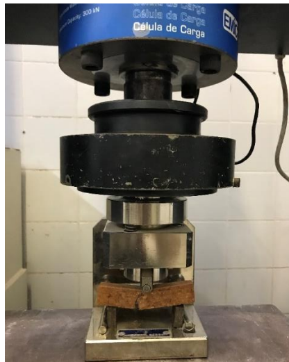
Figura 9 – Ruptura a flexão do corpo de prova
