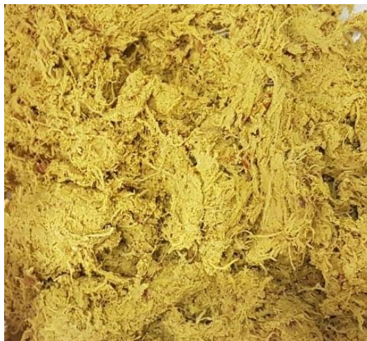
Figura 2 - Fibra de caju obtida a partir de pedúnculo processado em prensa expeller.
