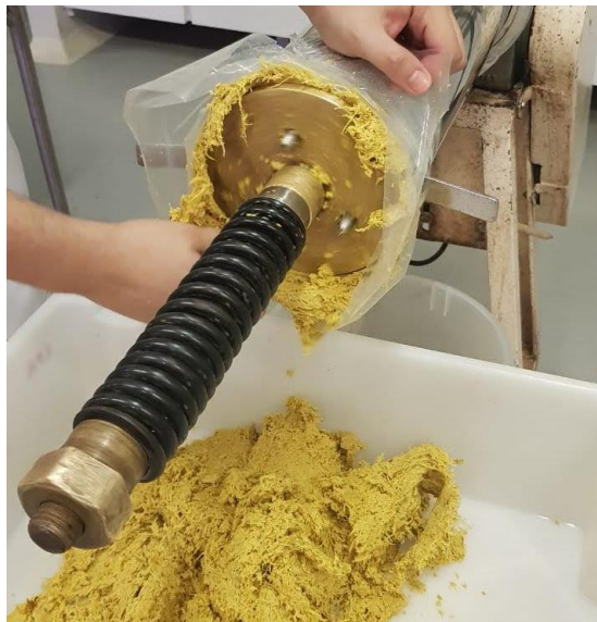
Figura 11 – Processamento da fibra de caju em prensa expeller (do tipo parafuso sem fim).
