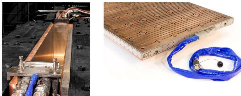
Figura 3 – Molde de cobre resfriado a água.
