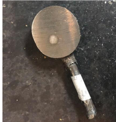
Figura 17 – Amostra de aço após análise no espectrômetro
