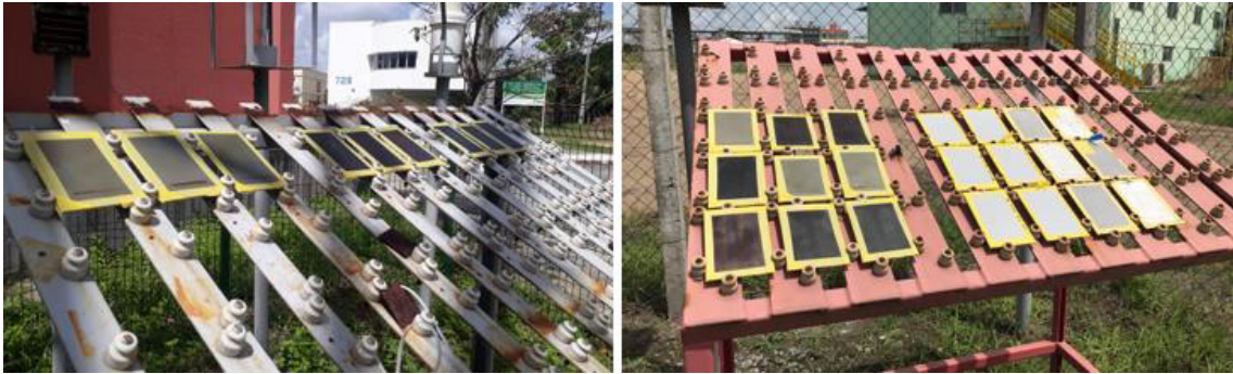
Figura 9 – Amostras preparadas para o ensaio de corrosão atmosférica nas estações da UFC, a esquerda, e da CSP, a direita.
