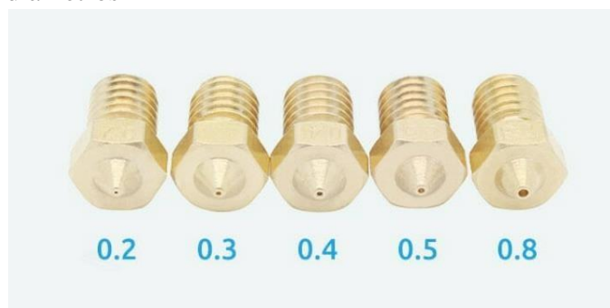
Figura 13 – Bicos de extrusão com diferentes diâmetros
