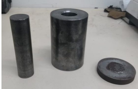
Figura 12 – Molde metálico utilizado na compactação dos pós
