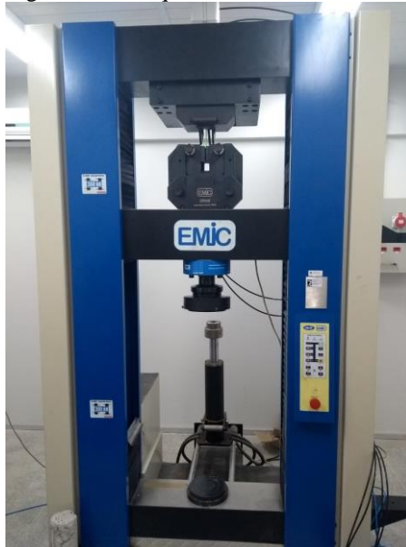
Figura 13 – Máquina de ensaios universal Emic
