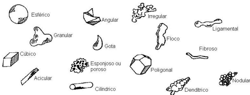
Figura 2 – Formas geométricas das partículas de pós metálicos
