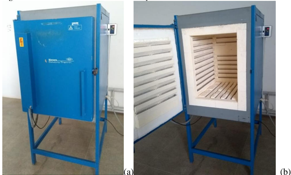
(a) Forno fechado. (b) Resistências no interior do forno Fonte: Elaborado pela autora
