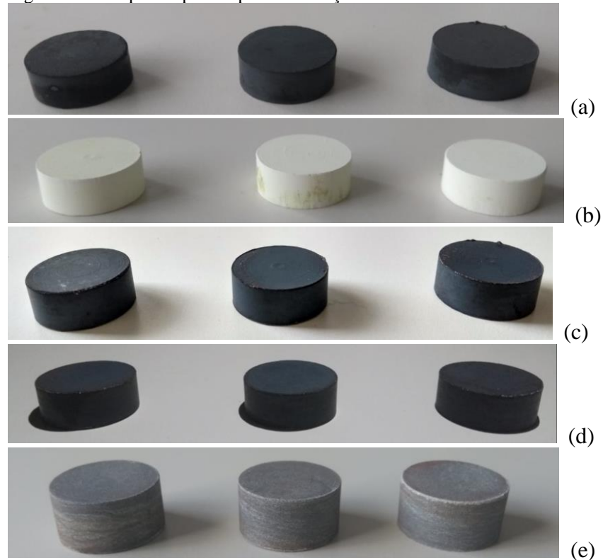
(a) CPs de alumínio (b) CPs de pentóxido de nióbio (c) CPs com 5% de Nb 2 O 5 (d) CPs com 10% de Nb 2 O 5 (e) CPs com 50% de Nb 2 O 5
