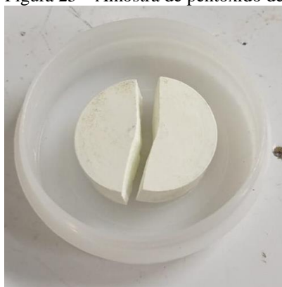
Figura 25 – Amostra de pentóxido de nióbio rompida
