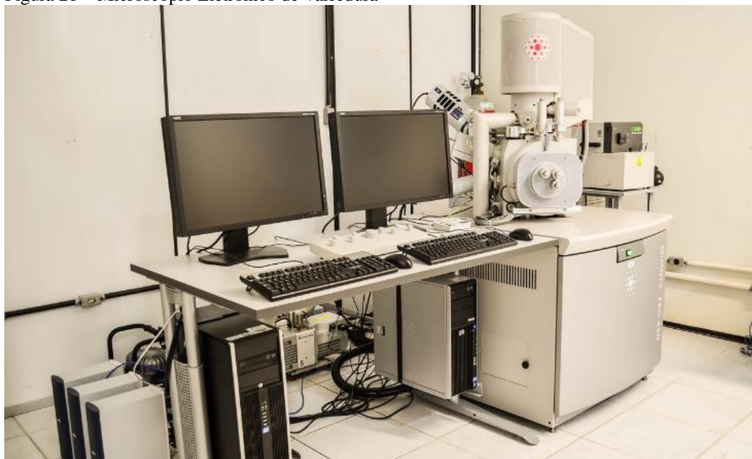
Figura 21 – Microscópio Eletrônico de Varredura
