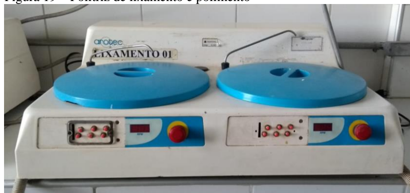
Figura 19 – Politriz de lixamento e polimento
