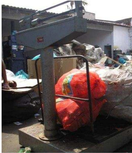
**FIGURA 8 – Balança para pesagem de materiais recicláveis**
