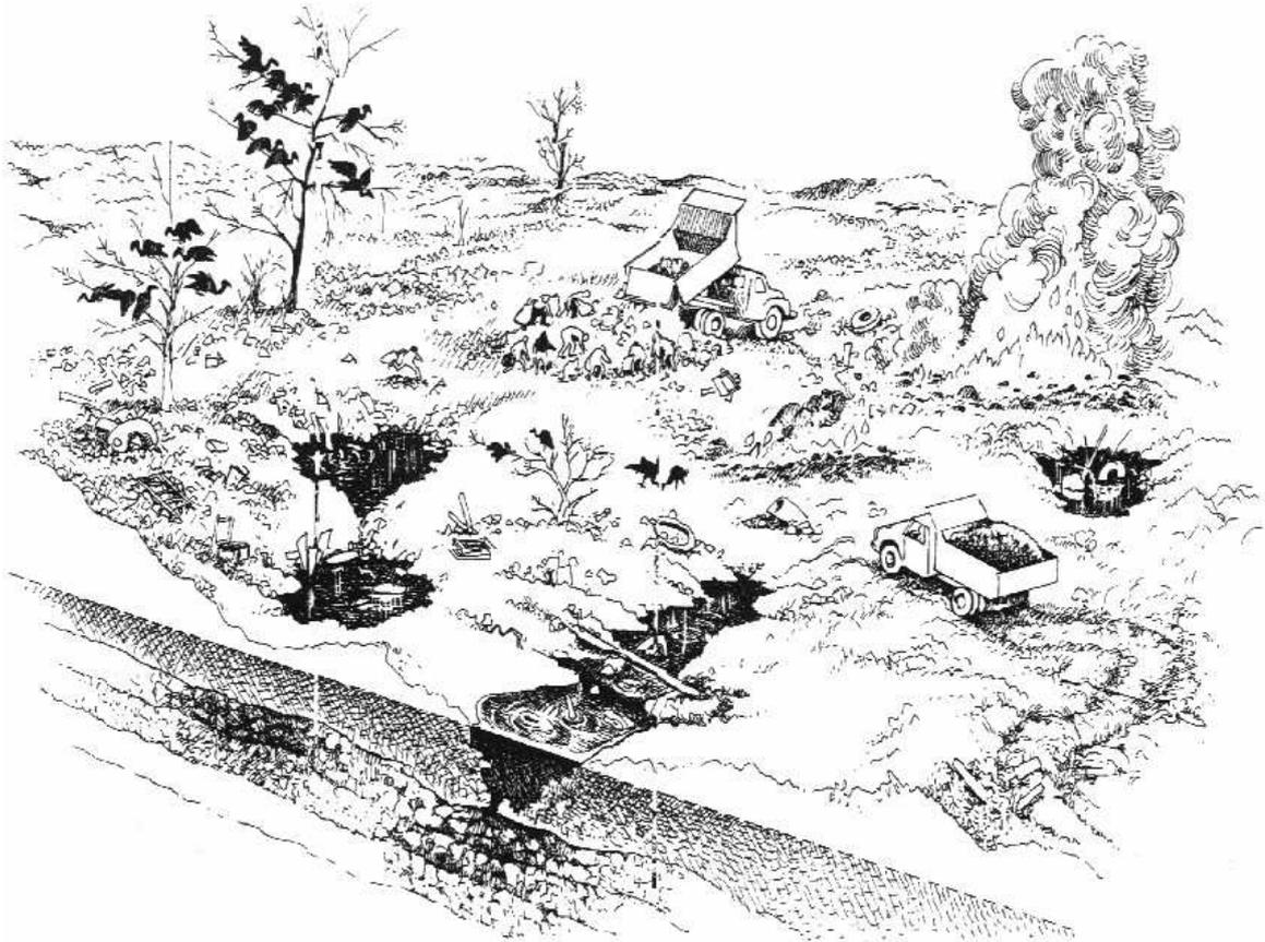
**FIGURA 2 - Esquema de um Lixão a céu-aberto mostrando a presença dos catadores e animais no local de descarga dos caminhões de resíduo e o acúmulo de chorume na superfície do solo, bem como a sua absorção pelas camadas do solo.**
