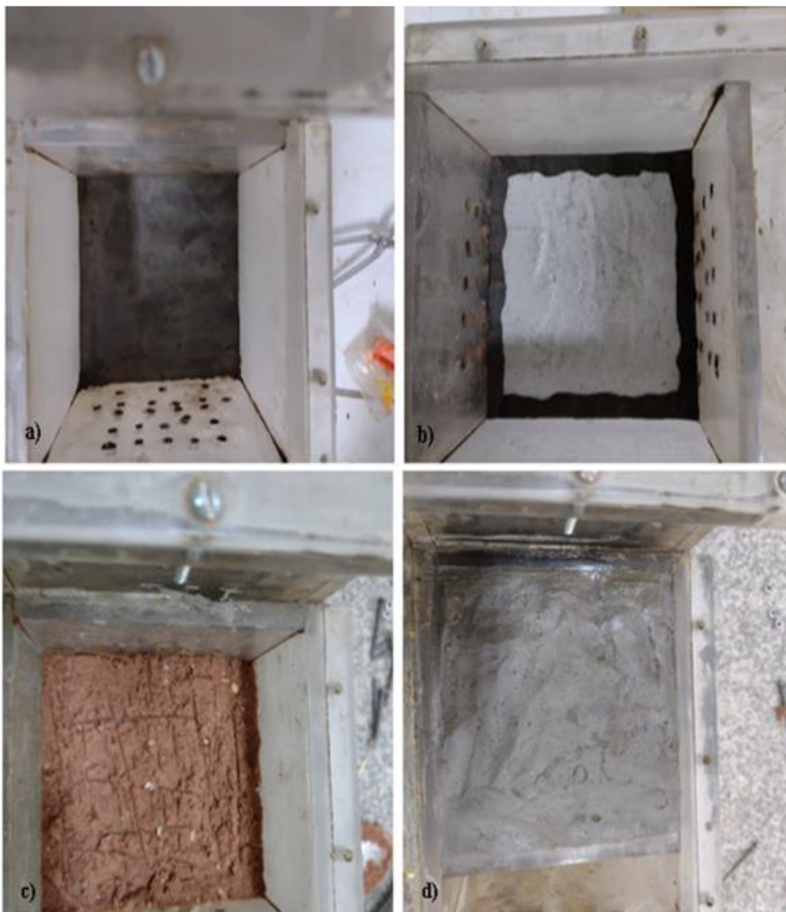
Figura 23 – Execução da montagem dos experimentos: a) Aplicação de bentonita; b) Instalação da placa; c) Compactação do solo; d) Última camada da aplicação de bentonita
