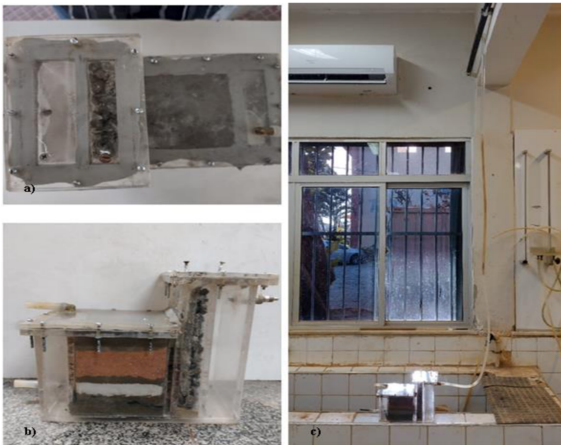
Figura 24 – Execução da montagem dos experimentos: a) Vedação completa do sistema; b) Sistema com água; c) Ensaio para a determinação dos coeficientes de permeabilidade;
