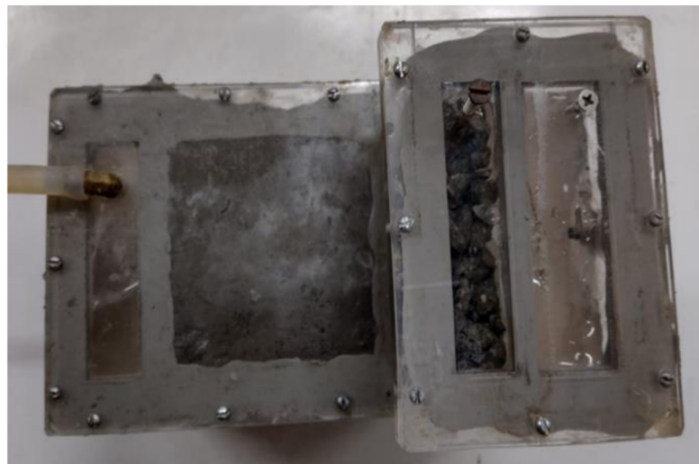
Figura 20 – Vedação do sistema utilizando massa para calafetação e parafusos
