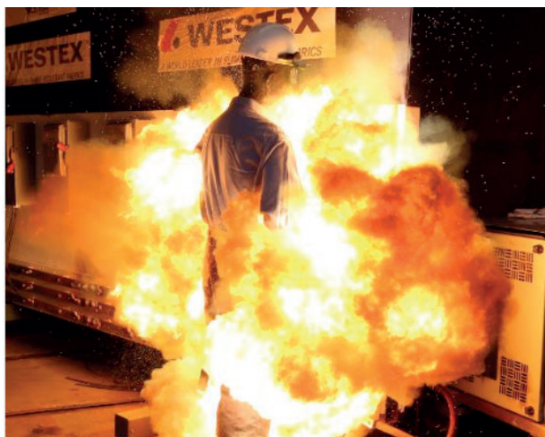
Figura 2 – Demonstração de explosão elétrica em ensaio laboratorial
