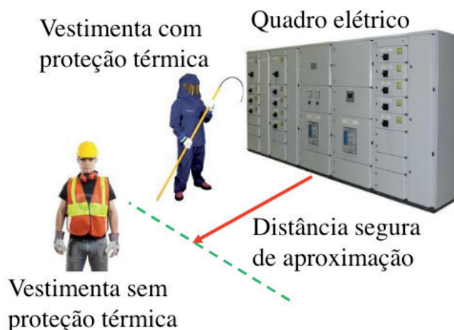
Figura 3 – Distância segura de aproximação em sistemas energizados
