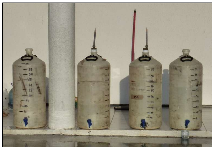
Fotografia 2 : Tanques de 60l e as tampas equipadas com o filtro – datação pelo ^{14}\text{C}
