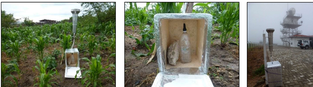
Fotografia 1 : Vista do sistema de coleta das águas de chuva elaborado para monitorar a composição isotópica das chuvas
