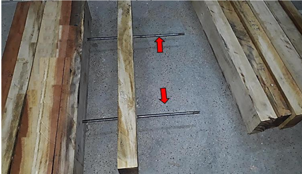
Figura 21 - Duas barras de sustentação para um módulo da pista de vibração
