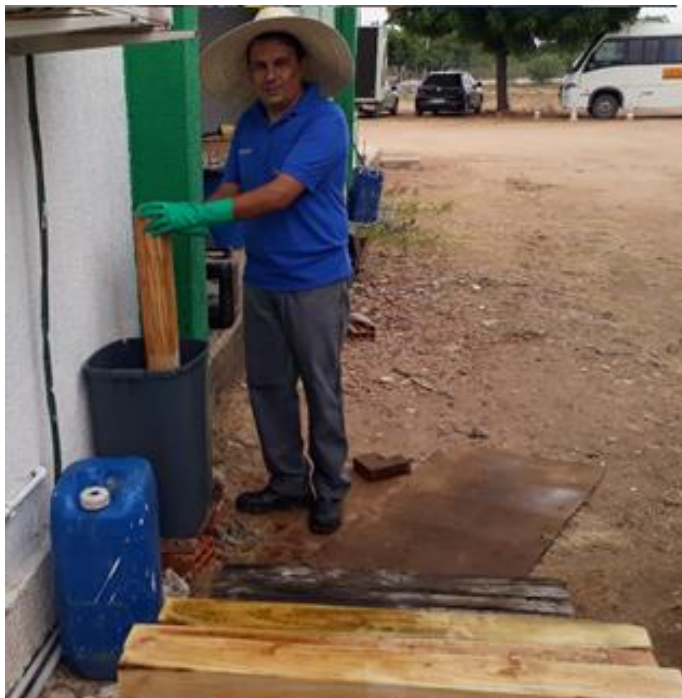
Figura 16 - Imersão em mistura de óleo Diesel e lubrificante automotivo
