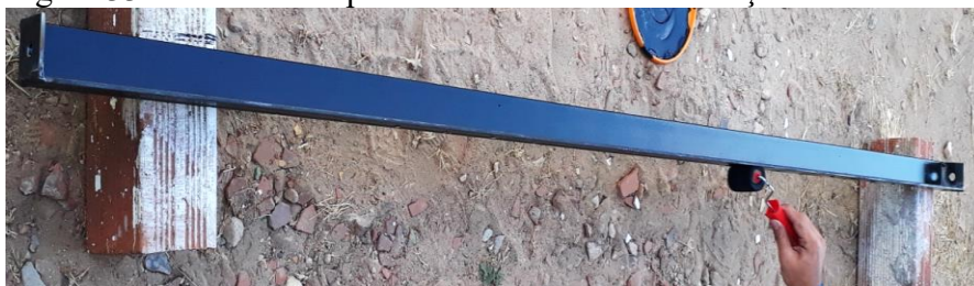
Figura 33 - Processo de pintura em barra de sustentação lateral
