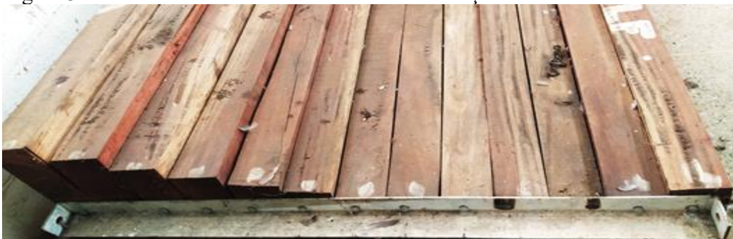
Figura 31 - Módulo montado com barras de sustentação lateral
