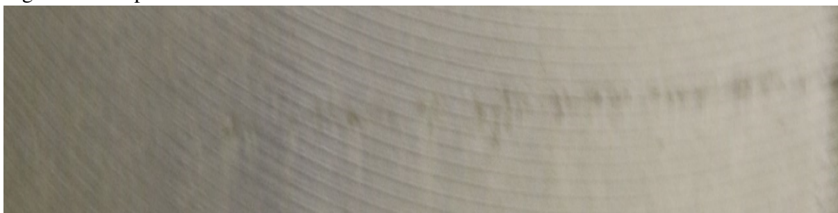
Figura 78 – Impressão de Baumann – Distribuidor Sola baixa
