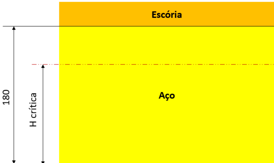
Figura 35 – Altura da coluna de aço dentro do distribuidor correspondente a 8 toneladas
