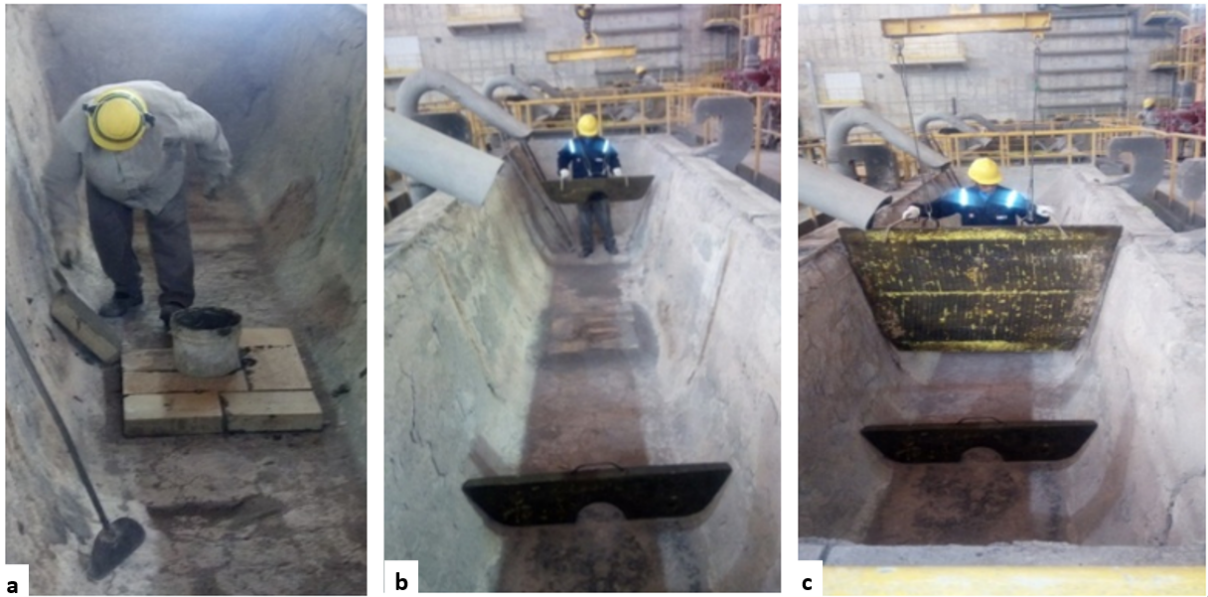
Figura 62 – Principais etapas da montagem do distribuidor com sola baixa e barragem
