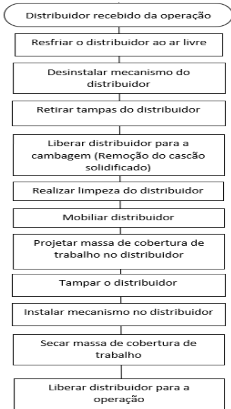
Figura 60 – Fluxograma do processo de montagem e disponibilização de um distribuidor
