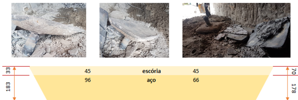
Figura 80 – Medição da altura do cascão do distribuidor com sola baixa
