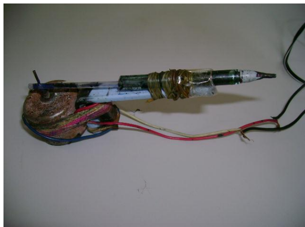
Figura 6: Máquina de fazer tatuagem Foto: Arquivo da PIRS
