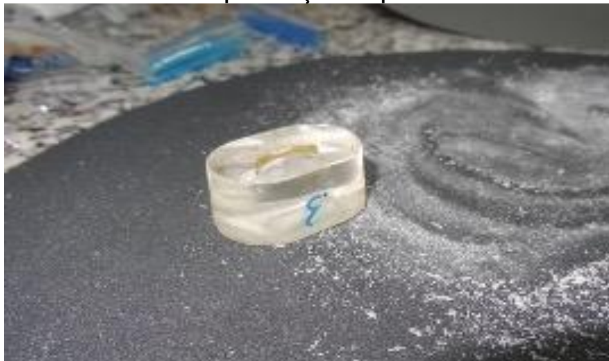
Foto 7 - Bloco de acrílico após remoção da superfície soft com auxílio de lixa de 600 \mu\text{m}
