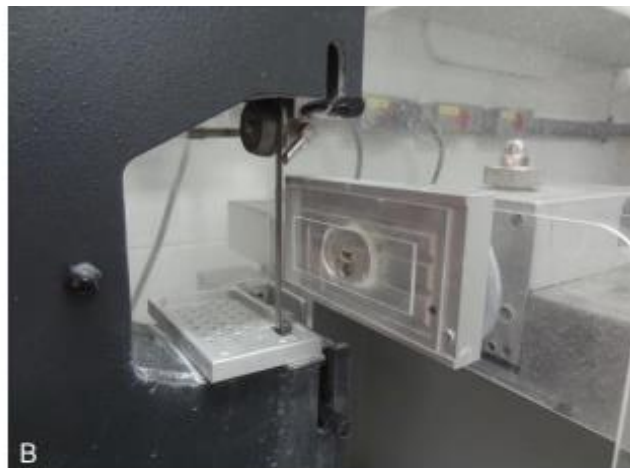
Foto 16 A e B - Momento que as amostras estão sendo cortadas por meio da utilização do Equipamento EXAKT 300 & 300 CP
