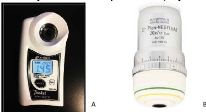
Foto 1 – Imagens de refratômetro e objetiva de microscópio light-sheet
