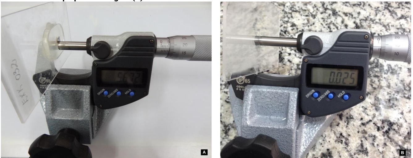
Foto 11 - Mensuração da espessura do sistema lâmina/cola/bloco no paquímetro digital (A). Mensuração da 2ª lâmina no paquímetro digital (B)
