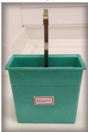
Foto 8 - Fixação das lâminas em banho
