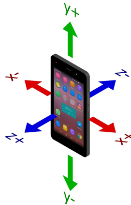
Figura 4 – Exemplo dos eixos dos sensores em um smartphone.
