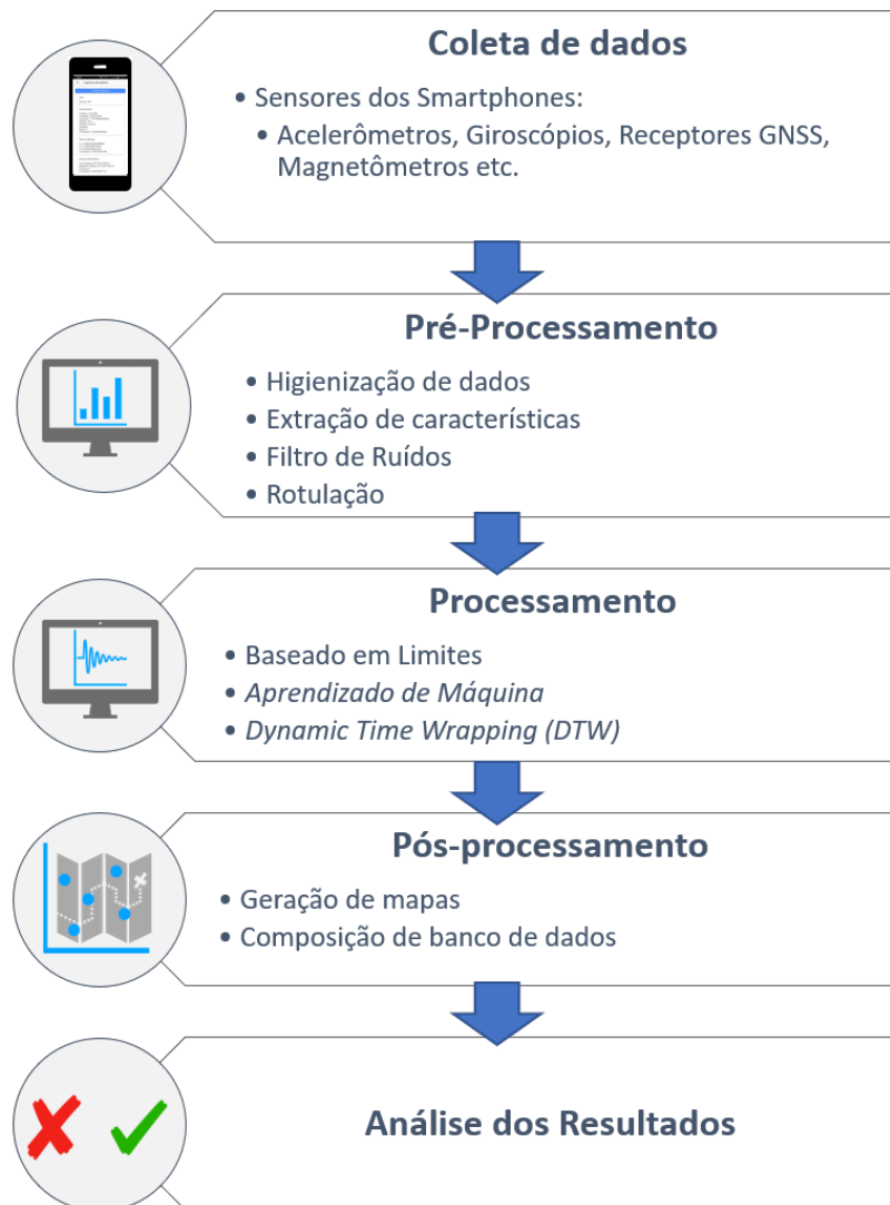
Figura 15 – Esquema processo de identificação de irregularidades de superfície no pavimento por meio de sensores de smartphones.
