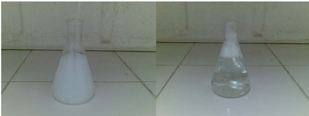
Figura 16: Mudança de cor no tratamento UV/H 2 O 2 na presença do ânion bicarbonato (CO 3 2- ) na remoção do agrotóxico.
