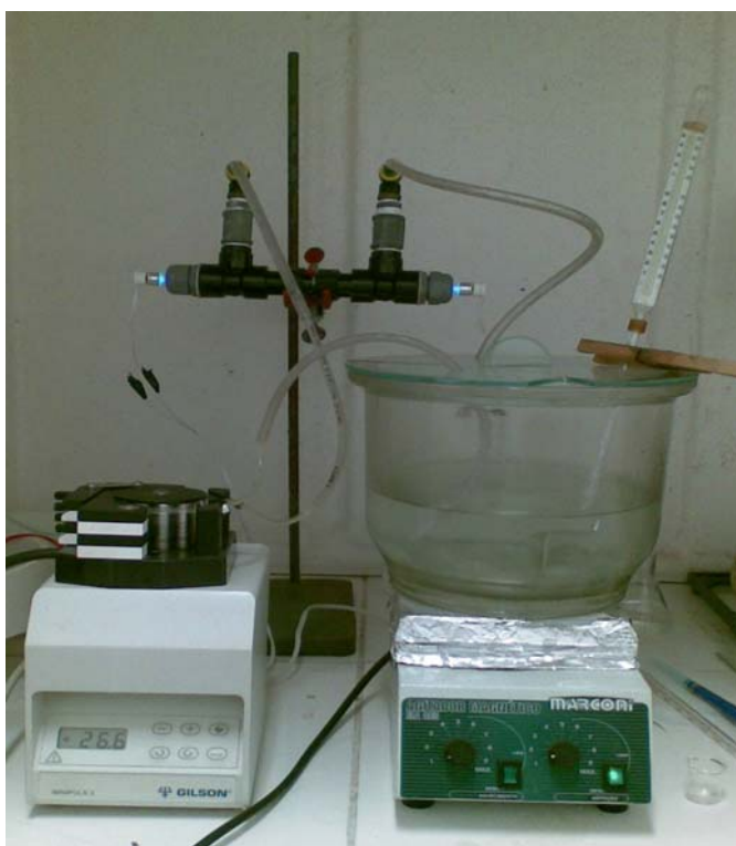
Figura 4: Foto do reator fotoquímico usado no tratamento
