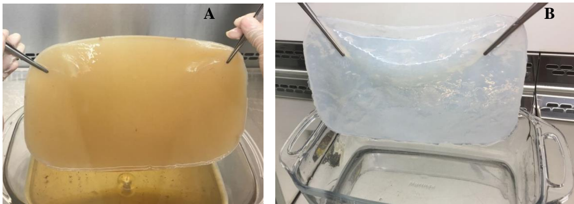
Figura 8- CB após os 10 dias de fermentação (A); CB após o processo de purificação (B).
