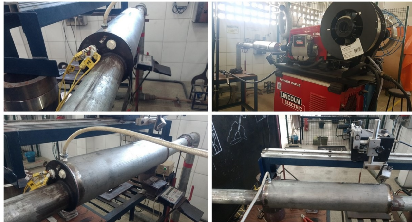
Figura 25 – Bancada experimental para soldagem do tubo de aço inoxidável AISI 321
