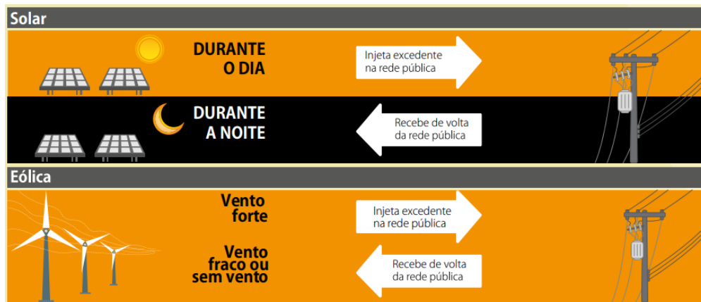
Figura 8 – Resumo de como funciona o sistema de compensação elétrica para energia solar e energia eólica
