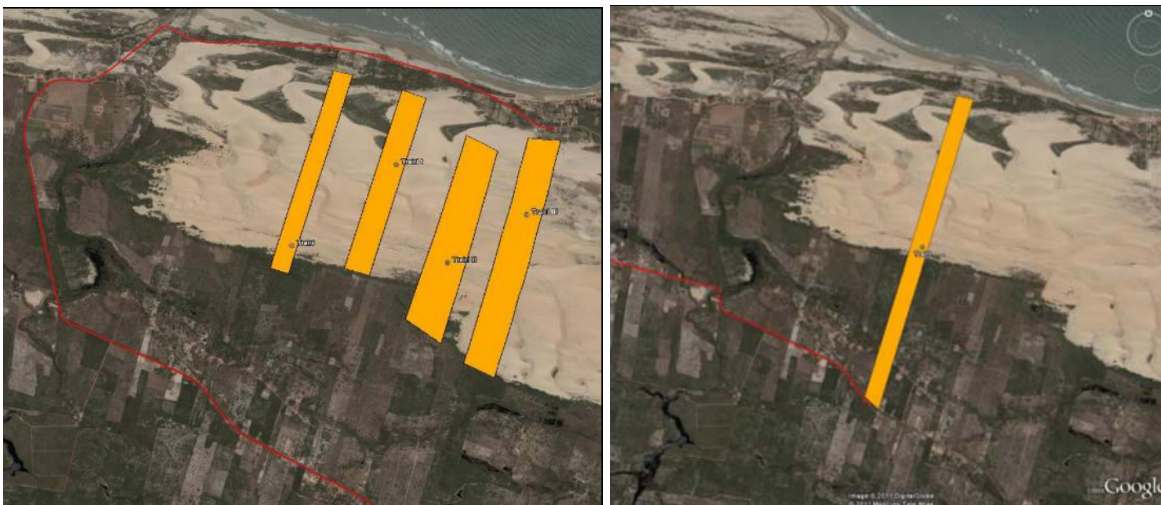
Figura 11 – Alterações no projeto da Central Eólica Trairi da fase de licenciamento prévio em 2008, à esquerda, a concepção final em 2011, à direita.
