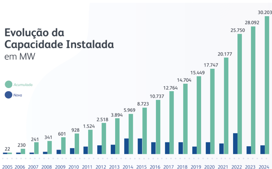
Gráfico 4 – Evolução da capacidade instalada de energia eólica no Brasil.
