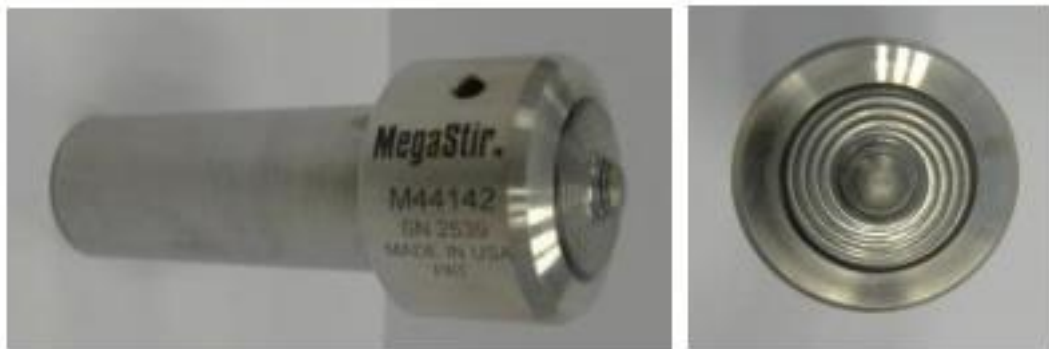
Figura 10 – Ferramenta de PCBN utilizada
