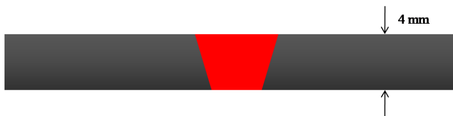
Figura 9 – Representação esquemática de uma junta de topo
