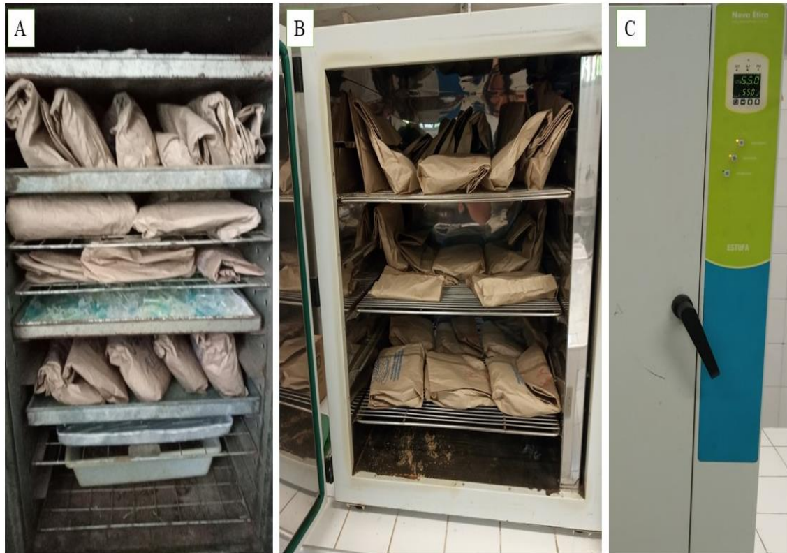
Figura 9 - Secagem das amostras em estufa de ventilação forçada a 55°C (A, B e C)
