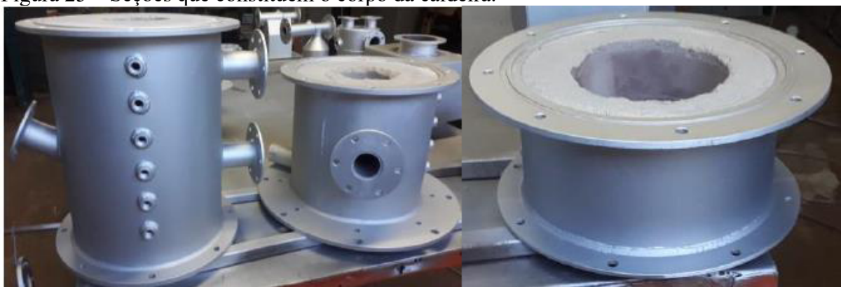
Figura 25 – Seções que constituem o corpo da caldeira.
