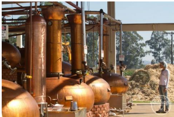
Figura 2 - Alambiques de cobre para a produção de cachaça artesanal
