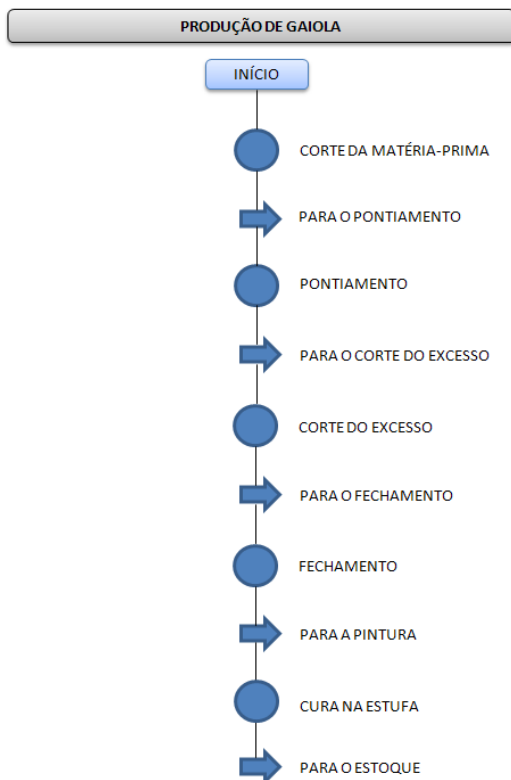
Figura 2 – Carta de fluxo de processo na produção de gaiola
