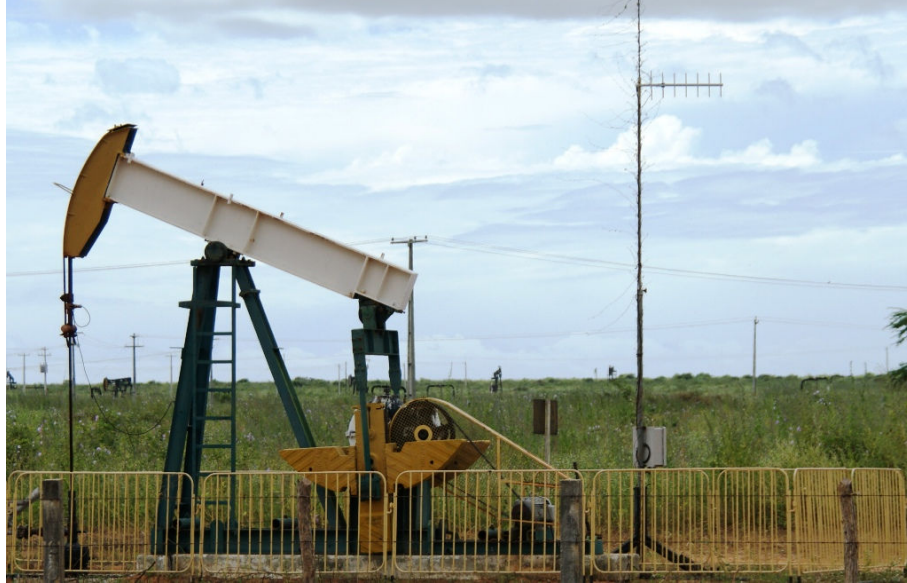
Figura 59 - Bombeamento mecânico de poço em Icapuí (cavalo-de-pau).
