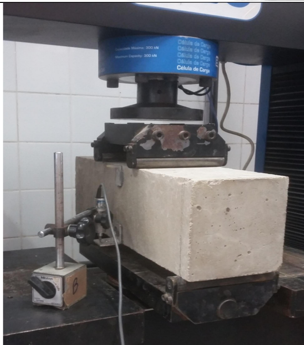
Figura 8. Instrumentação da viga com o LVDT
