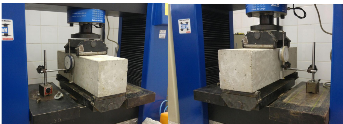
Figura 7. Instrumentação da viga com os relógios comparadores
