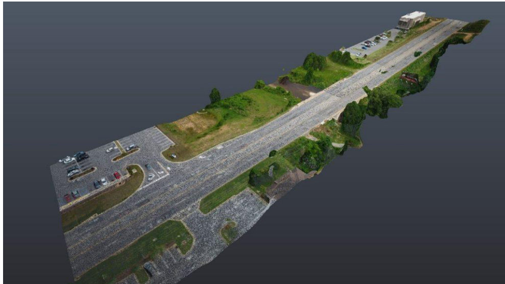
Figura 12 - Levantamento de Trecho de Rodovia feita com Drones
