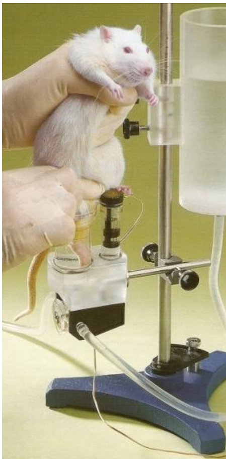
Figura 10. Medida do volume da pata traseira de rato em Pletismógrafo (Ugo Basile, Itália).
