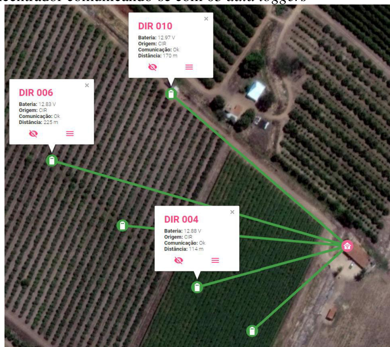
Figura 12 – Concentrador comunicando-se com 05 data loggers
