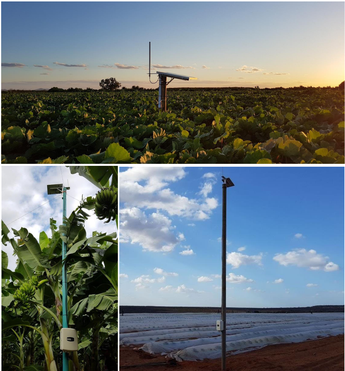
Figura 02 – Exemplos de data loggers instalados em culturas de uva, banana e melão
