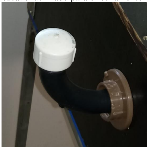
Figura 10 – Cap roscável utilizado para o fechamento da entrada de água
