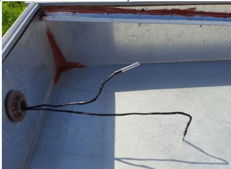
Figura 20 – Sensores DS18B20 na parte interna do dessalinizador
