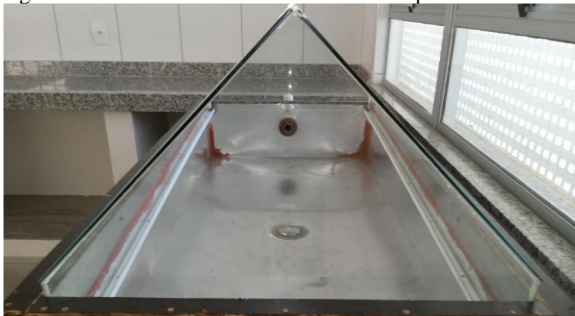
Figura 13 – Cobertura do dessalinizador sobreposta nas canaletas
