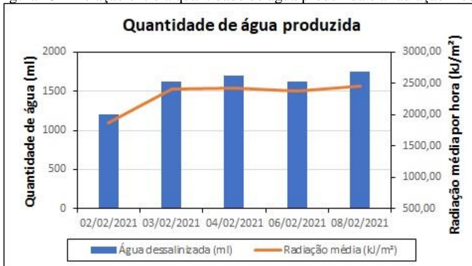
Figura 23 – Relação entre a quantidade de água produzida e a radiação média
