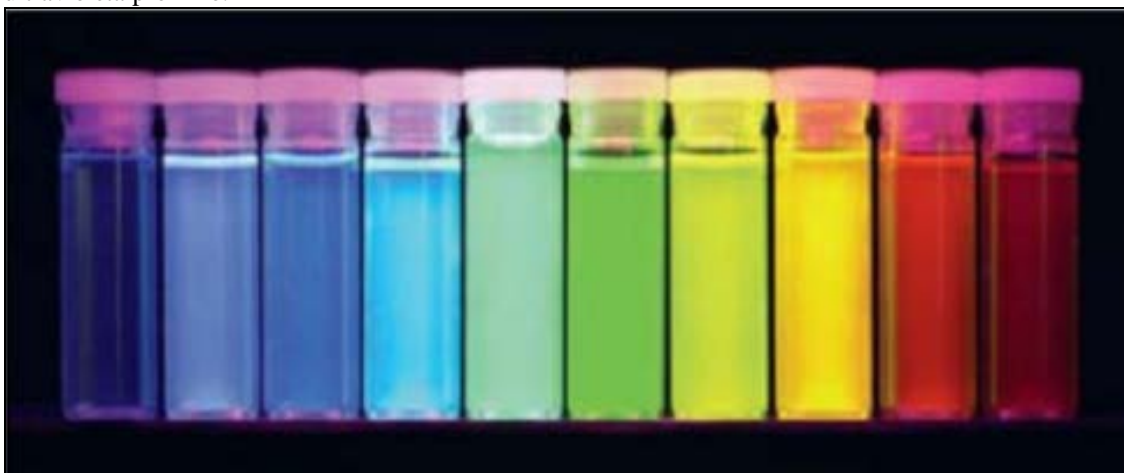
Figura 19 – Dez cores de emissão de pontos quânticos de CdSe/ZnS excitados com uma lâmpada no ultravioleta próximo.
